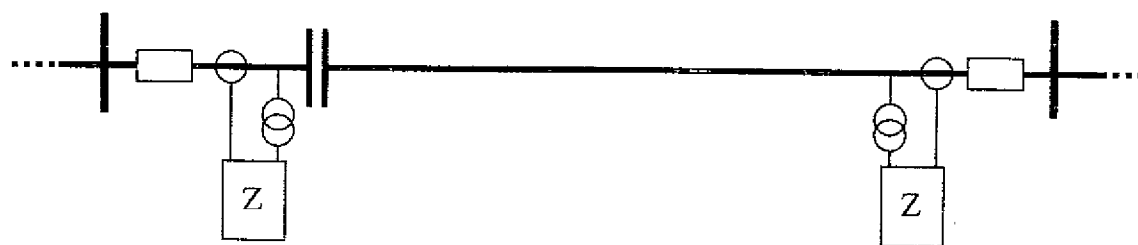
Fig. 6-75 (f): Banco en un extremo de la línea con TC y TV lado barra
