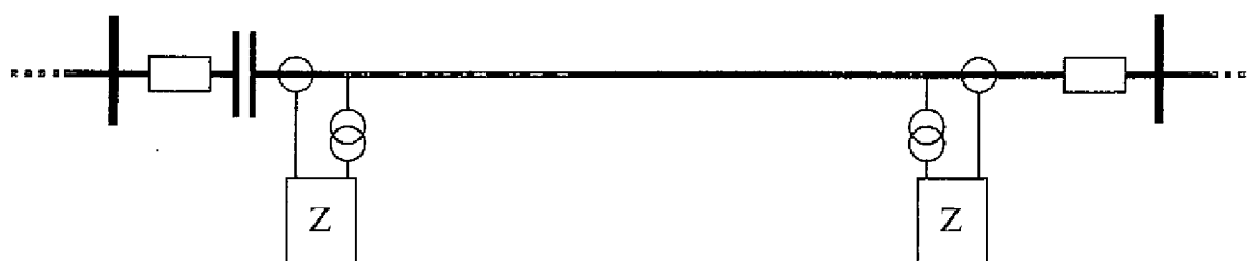
Fig. 6-75 (b): Bancos en un extremo de la línea con TC y TV lado línea
